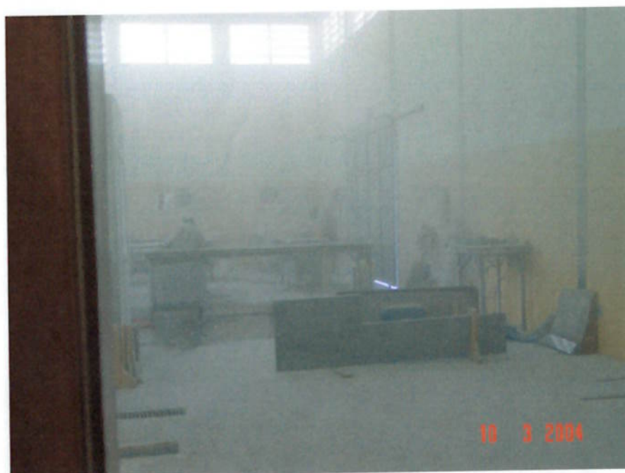
Fig.3.2 - Vista geral de uma marmoraria que utiliza processamento a seco Fonte: Bon (2006)
