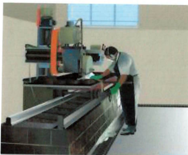
Fig.5.5 - Serra elétrica com alimentação contínua de água Fonte: Santos et al.(2008)
