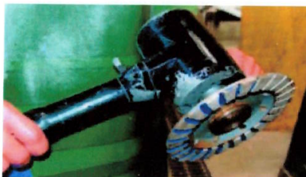
Fig.5.2- Lixadeira pneumática com disco de desbaste Fonte: Santos et al.(2008)
